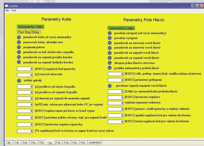
Příklad tabulky v systému pro nastavení parametrů plynového kotla a ovládacích hlavic topení.
